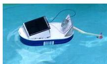
Beim Solarbastelkurs für Kinder und Jugendliche bauen wir aus Recycling-Material wie einer Fischdose, Karton und Strohalm ein Wasser-taugliches Boot, das von einer Photovoltaik-Zelle und einem Solarmotor mit einer Schiffsschraube angetrieben wird.
